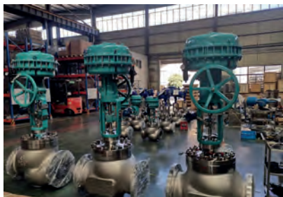
Рис. 3 Седельный тип клапана для установки на кислородно-регуляторном пункте (КРП)
