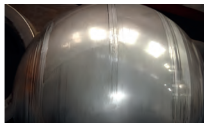
Рис. 2. Механические задиры на поверхности шара
